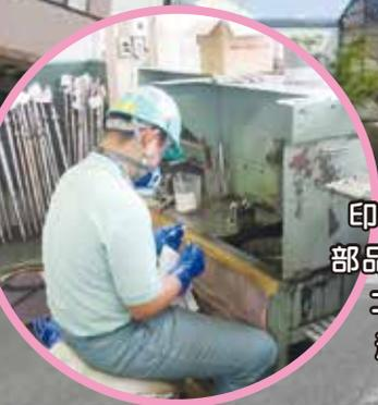
印刷機のローラーの部品を洗浄しています。コツコツと作業を頑張っています。
